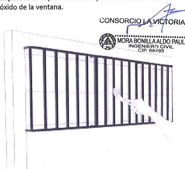
Reparación: Aplica base anticorrosiva o zincromato.
